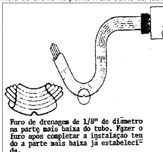
Figura 30: Orifício de dreno no ponto mais baixo da tubulação.
