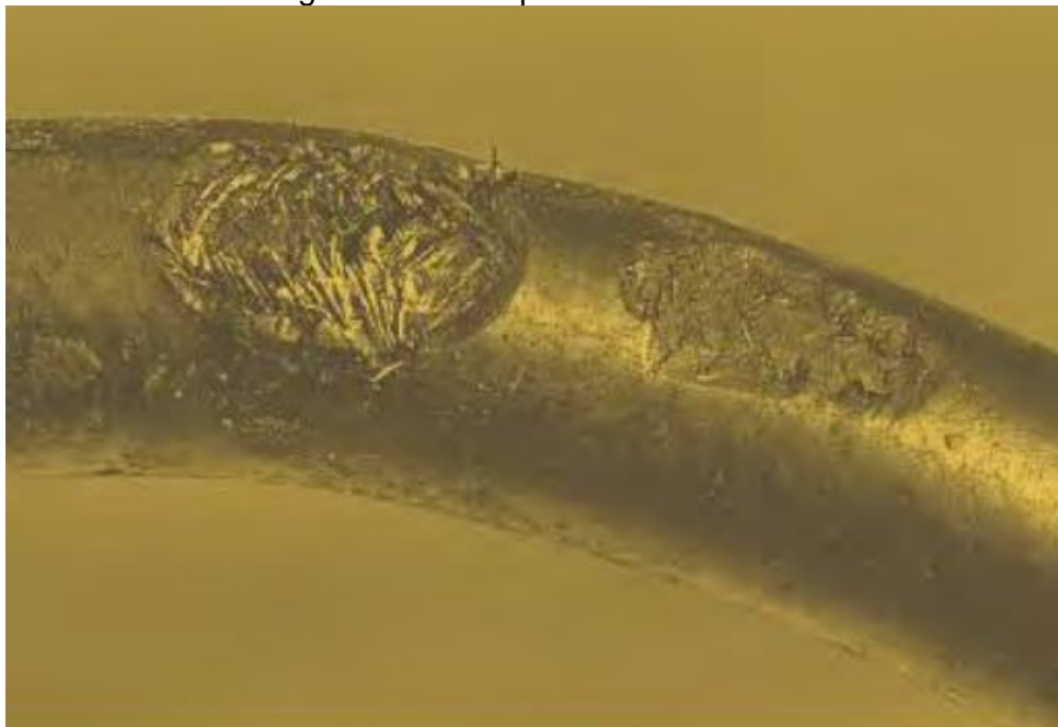
Figura 20: Falha por abrasão.
