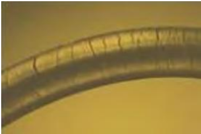
Figura 26: Falha por rachaduras na mangueira.
