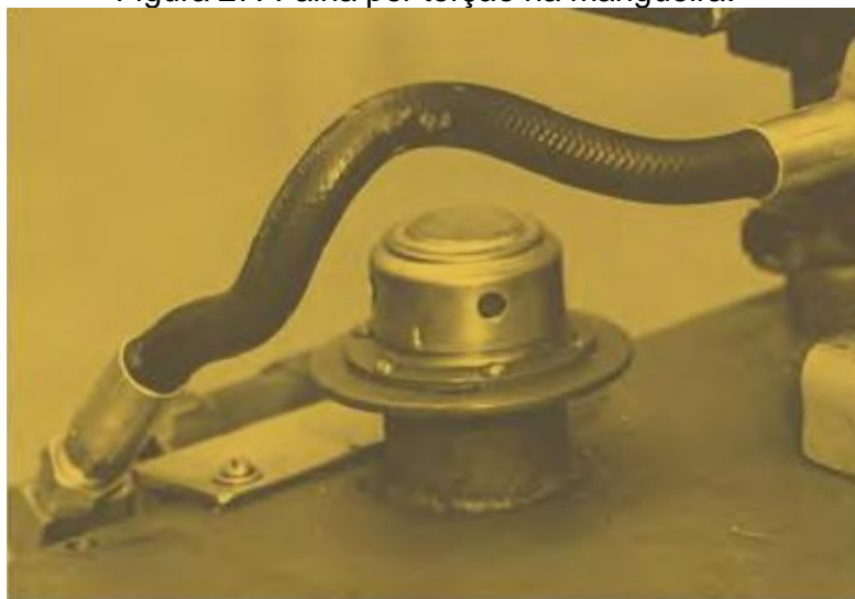
Figura 27: Falha por torção na mangueira.
