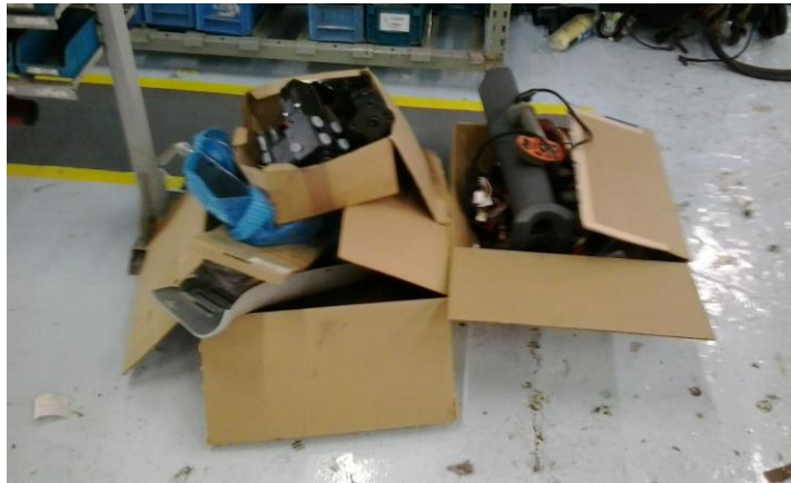
Figura 24 - Peças não conforme acondicionadas no posto de montagem sem identificação
