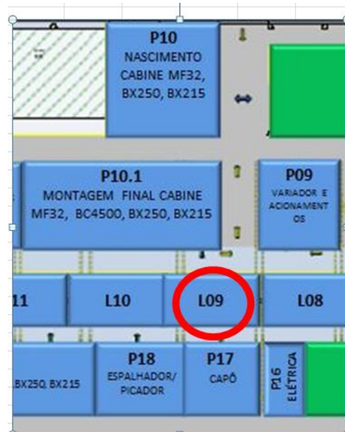
Figura 22 – Ponto de Recebimento da cabine na linha principal
