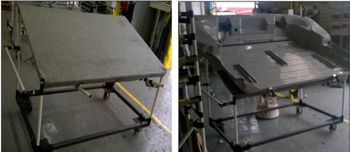
Figura 38 – Dispositivo de pré-montagem do teto
