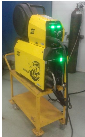
Figura 3 – Fonte utilizada na soldagem.
