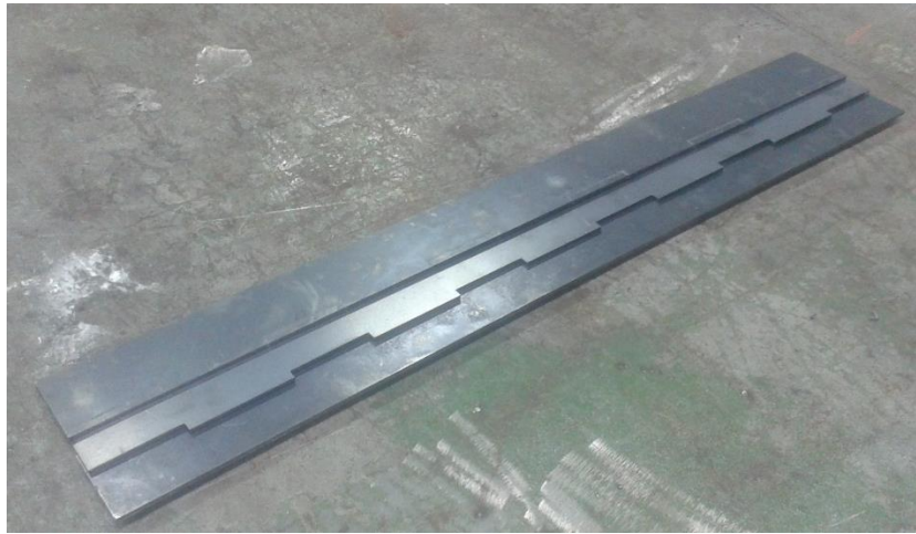
Figura 2 – Chapas posicionadas para a soldagem.
