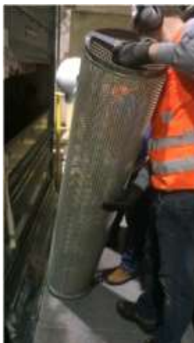
Figura 14: Limpeza da peneira classificadora
