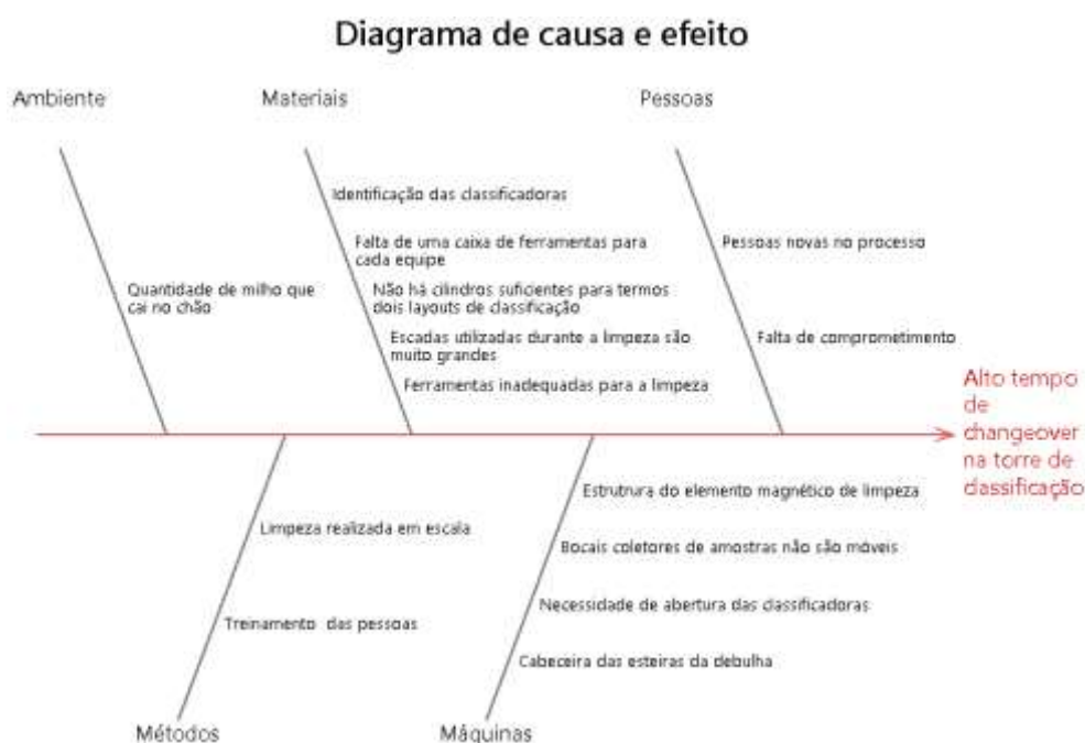
Figura 24: Diagrama de Causa e Efeito para o tempo de changeover na torre de classificação.
