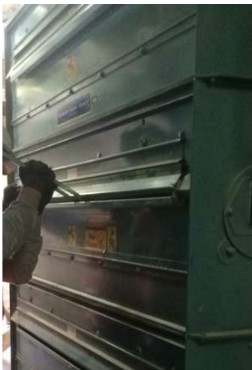
Figura 28: Novo sistema de tampas das carters
