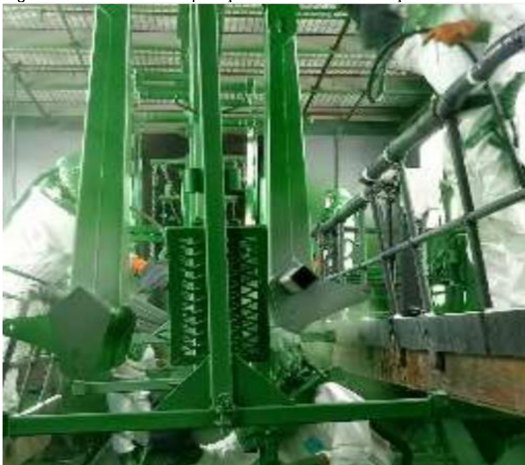
Figura 11 - Processo de aplicação de tinta no item lança
